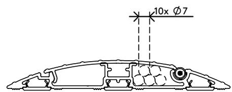
Addit Kabelschutz 60 cm - gerade 402
