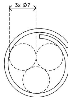
Addit bobina mangiacavo ø15 mm/3 m & utensile inseritore 731
